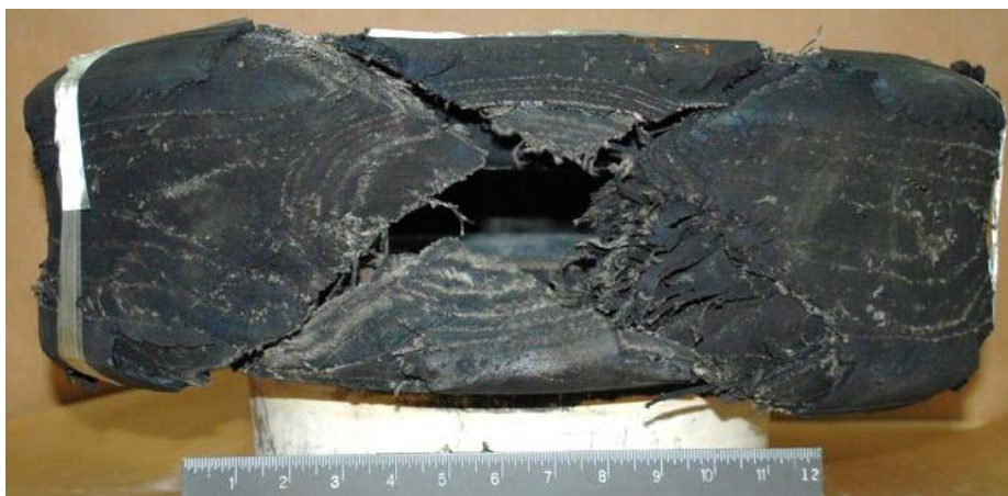
De aktuelle rester af dækket der viser flat spot og oprindelsen af dæksprængningen
