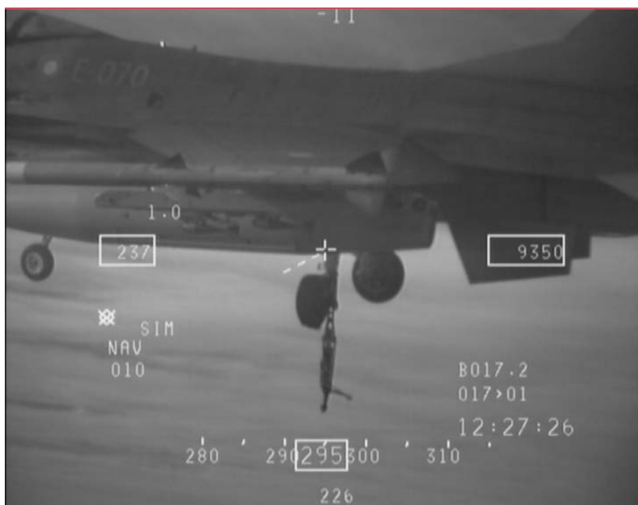
Billede fra Nr. 1 hjelmkamera: Venstre hovedhjul roteret 90 grader og med drag brace hængende stift under hjulet.
